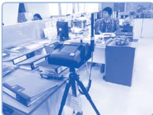
ตรวจวัดฝุ่น และคาร์บอนไดออกไซด์ ภายในหน่วยงานผู้เช่าอาคาร
