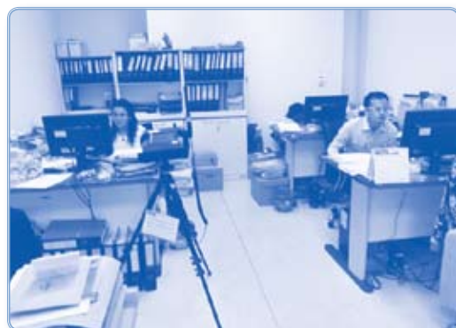
ตรวจวัดฝุ่น และคาร์บอนไดออกไซด์ ภายในหน่วยงานผู้เช่าอาคาร
